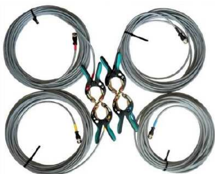
Conjunto de cables de ensayo de devanado de AT
