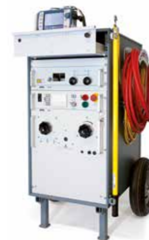
↑ Syscompact 2000 portable sirve para la prelocalización y la localización final de averías en cables de baja y media tensión y es ideal para el uso portátil sin necesidad de instalación permanente en un vehículo.
