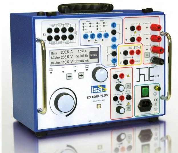
El TD1000 Plus tiene dos salidas de corriente para probar la curva característica de los relés diferenciales y no solo la corriente de pick-up. Además, la frecuencia de esta corriente puede cambiarse, al igual que la resistencia del segundo armónico del relé diferencial. Por último, la protección constante de la salida de tensión aumenta desde 30 VA a 50 VA.
