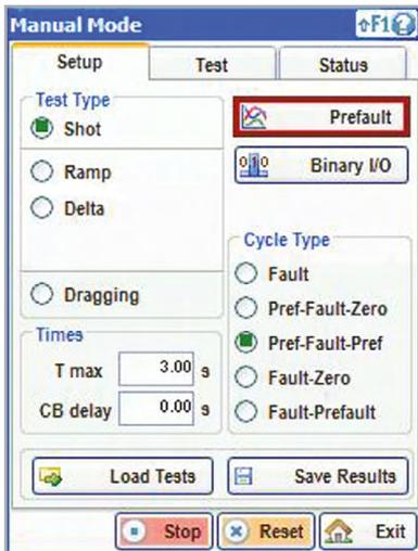
Ajuste de ensayo de relés de distancia
