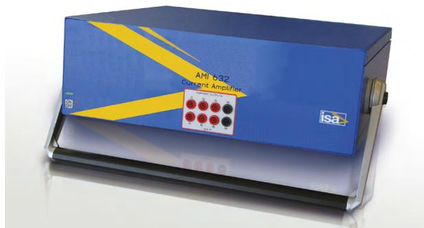
El amplificador de corriente de hexafásico AMI 632 es un equipo adicional para el DRTS 64. La opción precisa de la conexión IRIG-B y el módulo de extensión de salida en el DRTS 64 y incluye 6 generadores de corriente de 32 A cada uno. En conexión con el DRTS 64 la opción ofrece las siguientes características:
