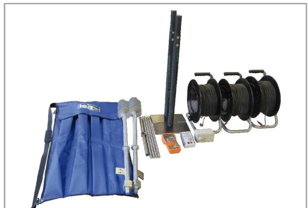
KIT DE ACCESORIOS PARA ENSAYOS DE LÍNEA Y MALLAS DE TIERRA
