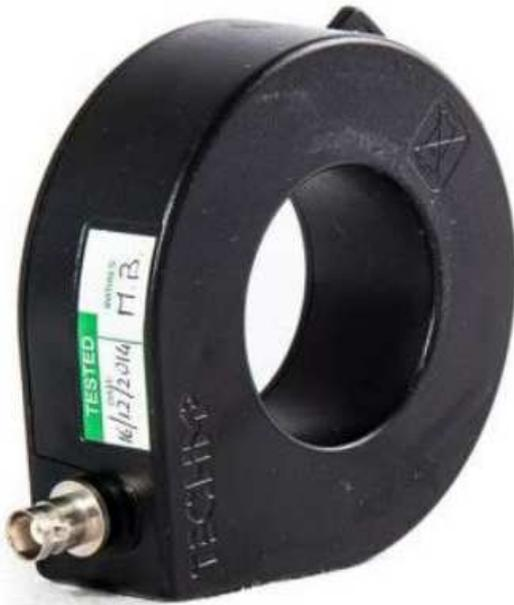
El transformador de corriente de alta frecuencia de Techimp modelo 50 es un sensor inductivo para medidas de descargas parciales. Es adecuado para ensayar PD en cables fuera de línea en muchas instalaciones eléctricas tales como cables, transformadores, máquinas rotativas, etc. Debe conectarse a la línea de puesta a tierra del equipo a ensayar.
