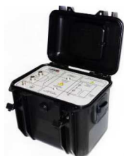
Transformadore de extensión CVT40
