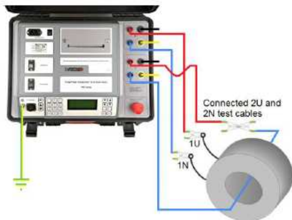
Conexión del TRT4X a un transformador de corriente desmontado
