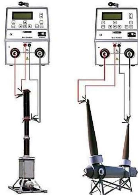
Conexión del cable del RMO-A en interruptores de tanque aislado o convencionales (izquierda) y en interruptores del tipo tanque muerto (derecha)
