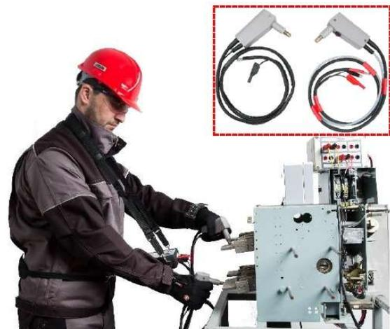
Cuando se ensaya un interruptor convencional de AT o cabinas o conexiones en líneas de potencia con el RMO-H, se pueden utilizar uno de los siguientes esquemas de conexionado:
