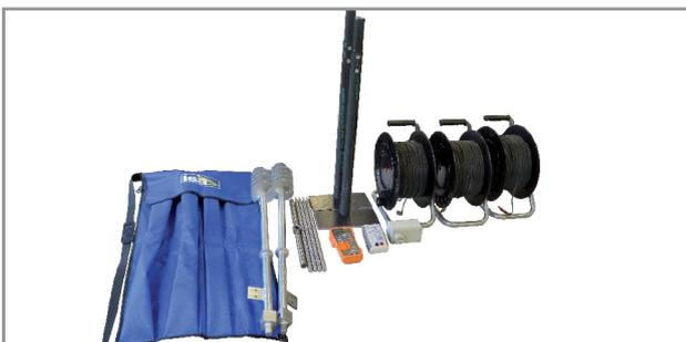
KIT DE ACCESORIOS PARA ENSAYOS DE LÍNEA Y MALLAS DE TIERRA
