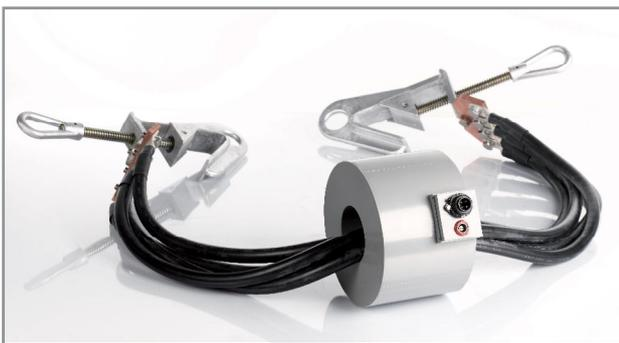
Kit para la medida de la impedancia de línea y ensayo de paso y contacto
