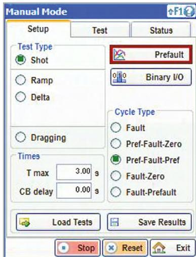
Ajuste de ensayo de relés de distancia
