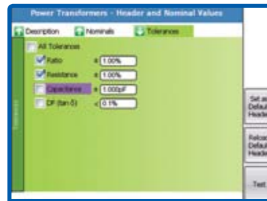
Ventana de tolerancias: permite configurar las tolerancias para cada una de las pruebas disponibles.
