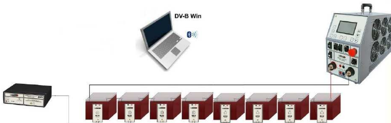
Diagrama de conexión de los componentes del Sistema BVS CM en combinación con el Equipo de carga de baterías
